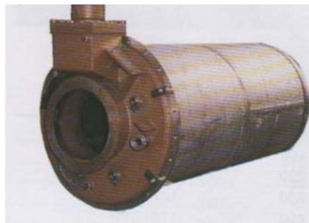
556®合金製の真空浸炭炉レトルト。
