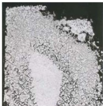
HAYNES® X 合金 平均腐食層厚さ＝ >22 mils(560 μm)/片側
