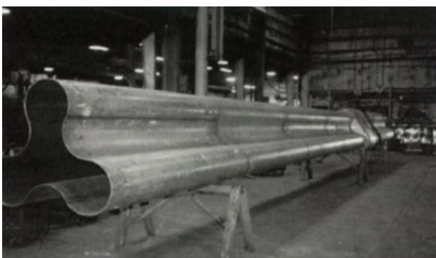
0.375 in (9.5 mm) のHR-160® プレートを溶接して製作した大型レトルト
