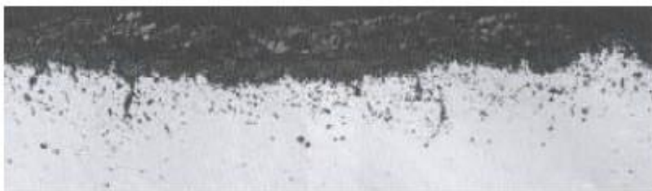
合金 800H 平均酸化層厚さ = 8.9 mils (226 μm)
