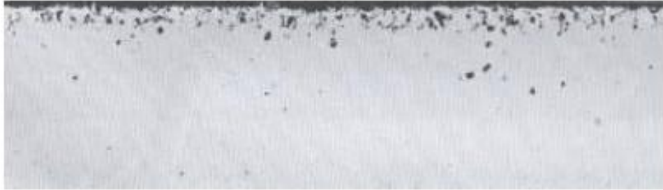
230° 合金 平均酸化層厚さ = 3.4 mils (86 μm)
