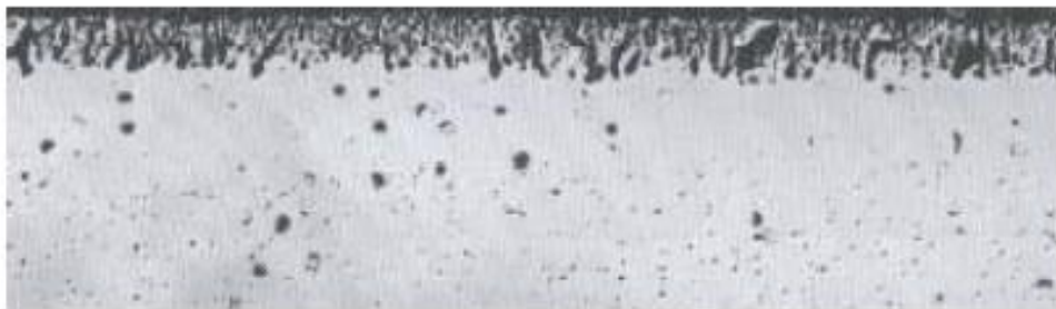
INCONEL 合金 601 平均酸化層厚さ = 5.3 mils (135 μm)
