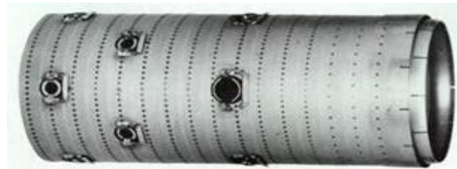
HAYNES® 230® 合金製の Textron Lycomingのガスタービン用燃焼器
