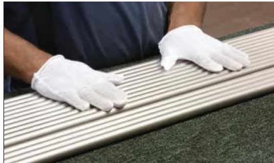
目視検査(白手袋検査)
